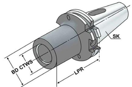
ISO 7388-1    Form AD/AF (AD/B)    ≤ 5µm    G6.3 15.000 min<sup>-1</sup>    RFID Chip    DIN 6383    AT5
