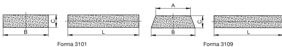
Segmentos para rectificado en plano consisten en una mezcla abrasiva como SD83A o SD85A para aceros de alta aleación y HSS o SD33A para aceros blandos y de baja aleación.
